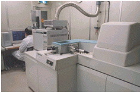
高分解能ガスクロマトグラフ質量分析装置
